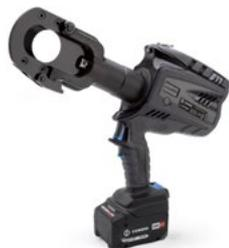
**UTENSILE OLEODINAMICO A BATTERIA TRANCIAFUNI, A PISTOLA, ADATTO PER CAVI IN RAME E IN ALLUMINIO E CAVI TELEFONICI CON Ø MAX 50MM**
